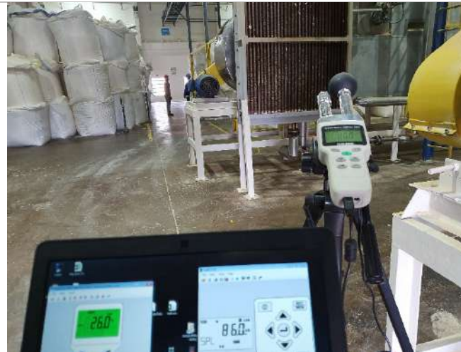
Foto 2 - Medição de Ruído e Calor.
