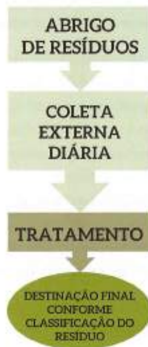
Imagem: Fluxo Unidirecional de Coleta Interna de Resíduos - Coleta e Transporte Externo.
